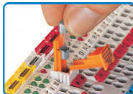
Функция в заблокированной позиции 2: для замены предохранителя надо просто откинуть крышку. Используйте только предохранители, имеющие одобрение UL!
