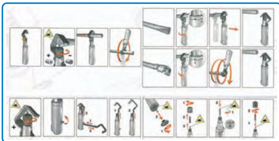
Инструкция по эксплуатации инструмента для зачистки кабелей 206-174
