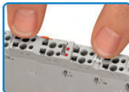
...вставьте разъем в модуль ввода-вывода.
