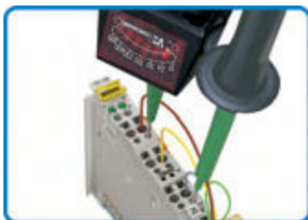
Проверка прохождения сигнала при подсоединенных проводниках
